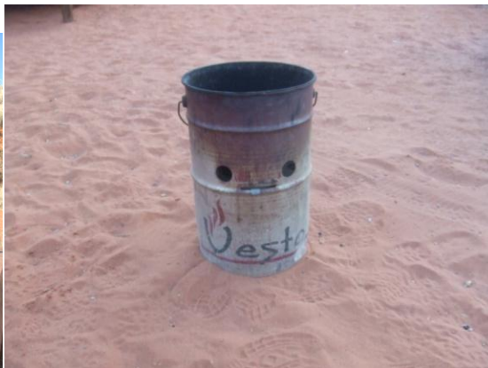
Figure4: Vesto Fuel-Efficient Stove (Photo: Vilho).
